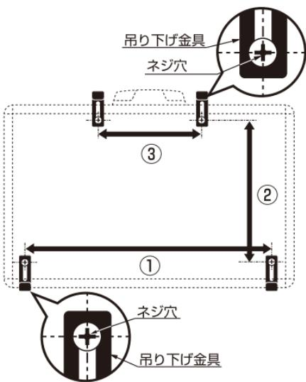
下記の表に従い、吊り下げ金具を正確な位置にネジでしっかりと取り付けてください。
