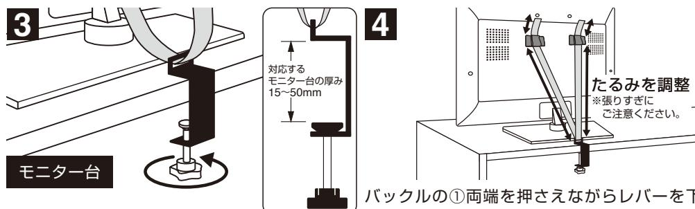
クランプをモニターベースの間にかませるようにして、ハンドルを回し固定します。
