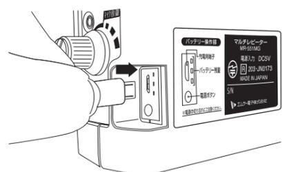
充電の進行に伴いマルチレピーターのバッテリー残量表示の目安が1目盛ずつ点滅→点灯していきます。3目盛すべてが点灯すると満充電です。
