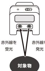
●直射日光や強い光が当たると、赤外線の反射が正しくできず、正確に測定できない場合があります。
