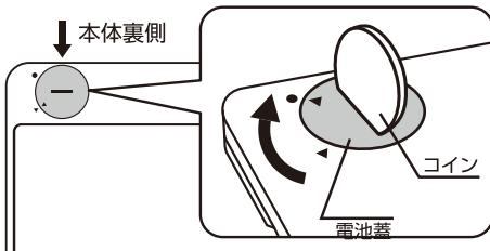
2. コイン型リチウム電池(CR2032)を交換します。
