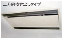
二方向吹き出しタイプ 650mm～1,100mm×550mmまで (長方形タイプ、中央部鉄板) ※別売のHBF-JM2(マグネット) のご利用で取り付けが可能です。
